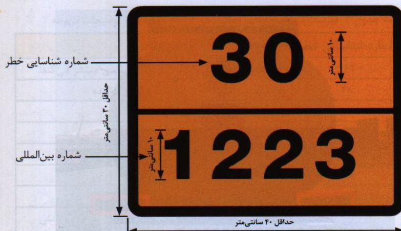
شکل ۱۵. نمایی از پلاک نارنجی رنگ مخصوص شناسایی مواد خطرناک
