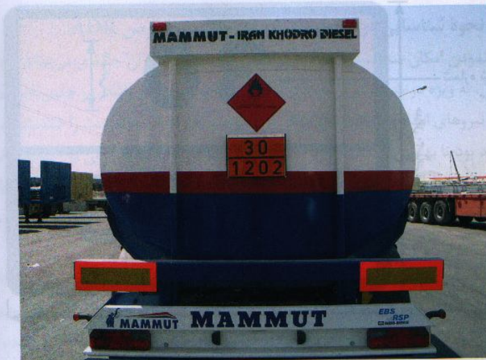
شکل ۱۶. طریقه صحیح نصب پلاکارد در عقب وسیله نقلیه (شماره شناسایی گازوئیل)
